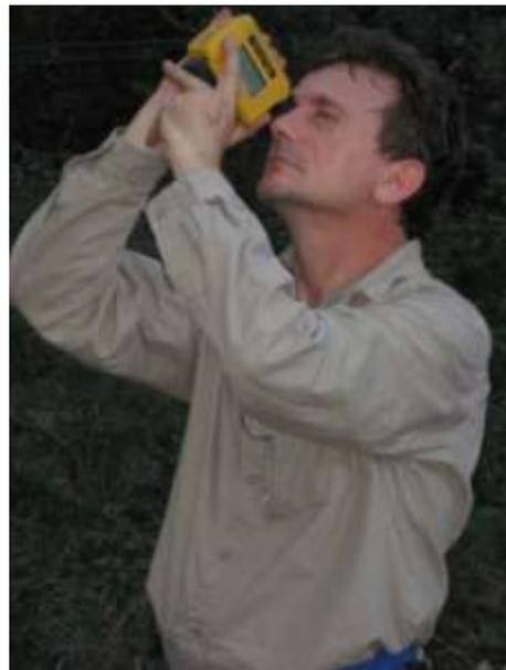
Mensuration des hauteurs et diamètres par visée (dendromètre électronique)
